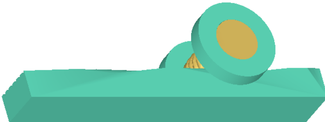
Рис. 2. Твердотельная модель процесса получения резьбы М6 накатыванием
