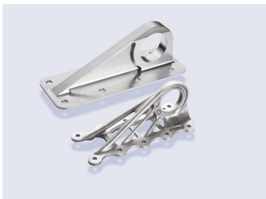
Рис. 2. Топологическая оптимизация кронштейна
