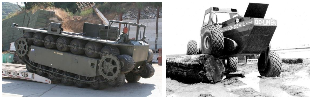
Рис. 4. АМ с катково-гусеничным типом движителя ( а ) и с колесно-шагающим движителем ( б )
