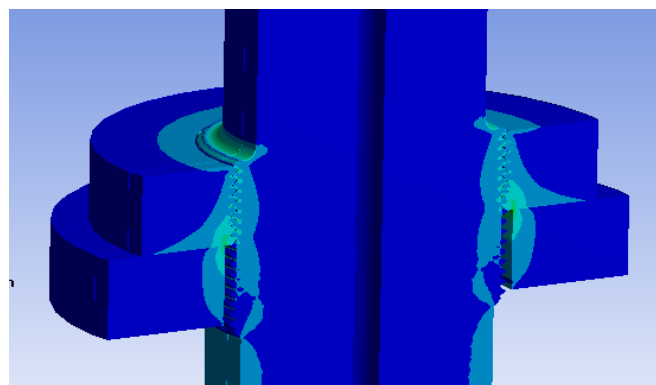
Рис. 6. Поля распределения эквивалентных напряжений \sigma_{\text{ЭКВ}}
