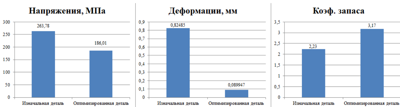
Рис. 5. Результаты расчетов исходной и оптимизированной детали
